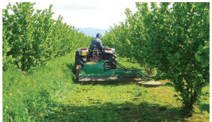
▲ Fig. 9 - È sempre più diffusa nei nocciolati la tecnica di gestione del suolo "a pratino", che utilizza macchine trinciatrici (comunemente dette "trincia") per il controllo del cotico erboso. Nella foto, una trinciatrice con disco interfilare dotato di tastatore.
