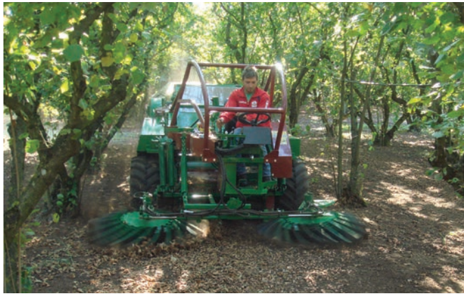
▲ Fig. 7 - Raccogliatrice semovente Semek. La raccolta avviene con spazzole di gomma che raccolgono il prodotto da terra e lo sollevano. Interamente, altri dispositivi consentono la pulizia, la cernita e lo stoccaggio in carrelli o in sacchi.
