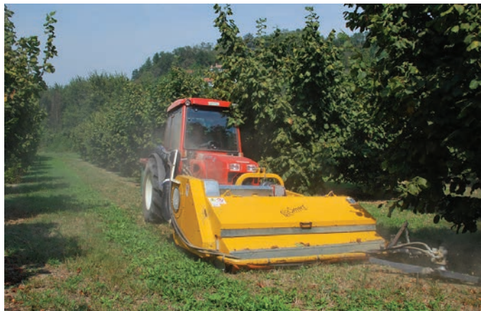
▲ Fig. 1 - Raccattrice portata frontalmente alla trattore provvista di sistema di rientro idraulico.
