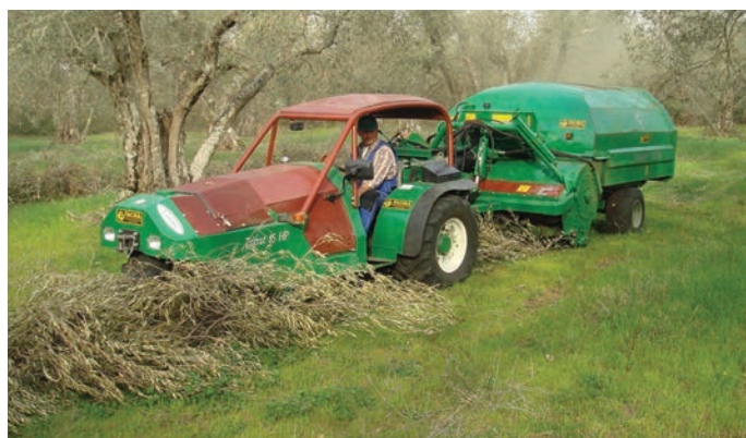
▲ Fig. 5 - La raccolta dei residui di potatura del nocciolo, oltre ad evitare danni all'ambiente derivati dalla loro bruciatura a bordo campo, può rappresentare un'interessante fonte di energia rinnovabile. Nella foto la trincia raccogliatrice Comby della Facma all'interno di un oliveto.
