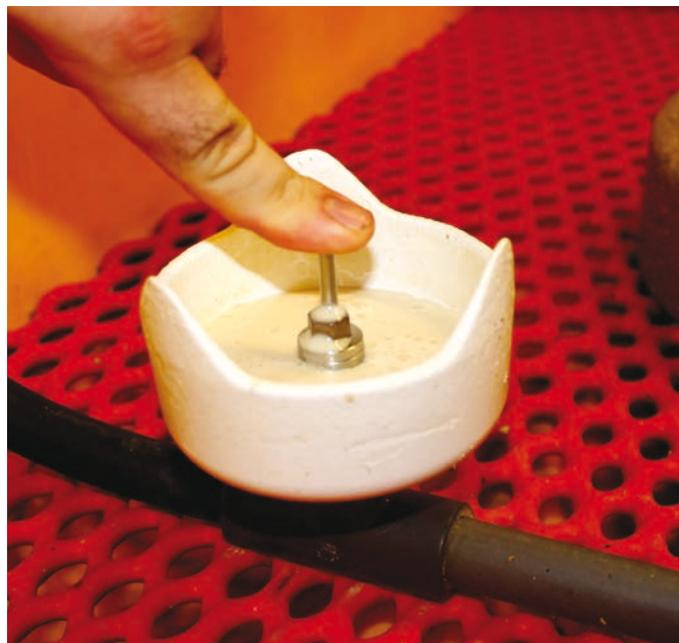
Foto 5 - Tazzetta presente nel Deck, con la pressione sul perno viene rilasciato latte ricostituito.
