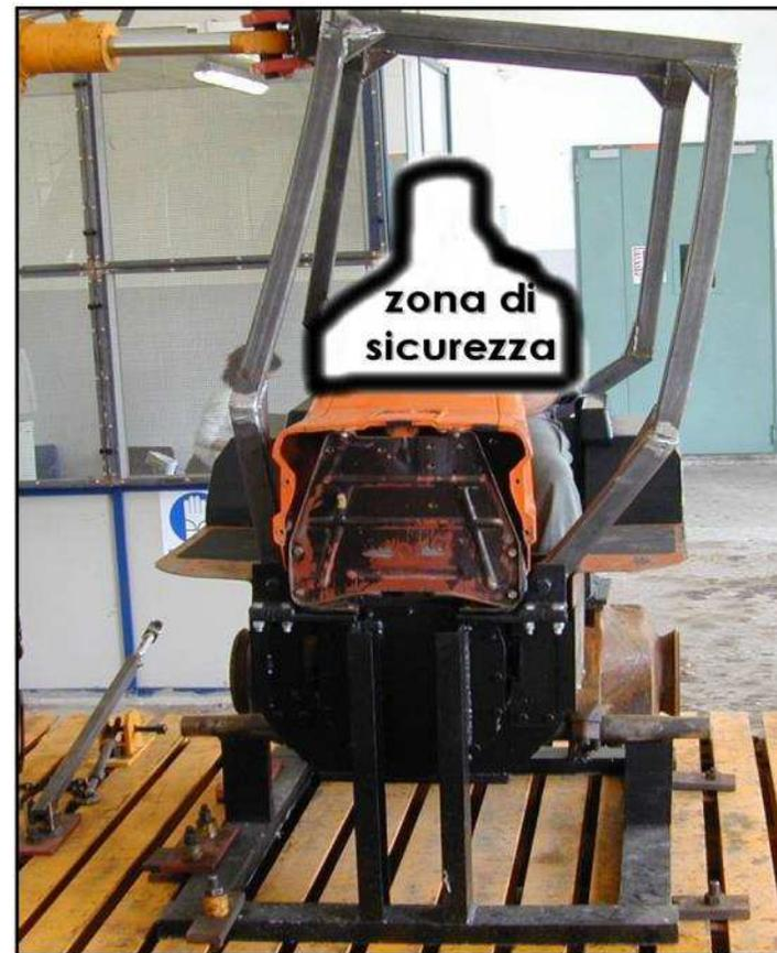
Prove statiche di tenuta del telaio eseguite secondo i Codici OCSE
