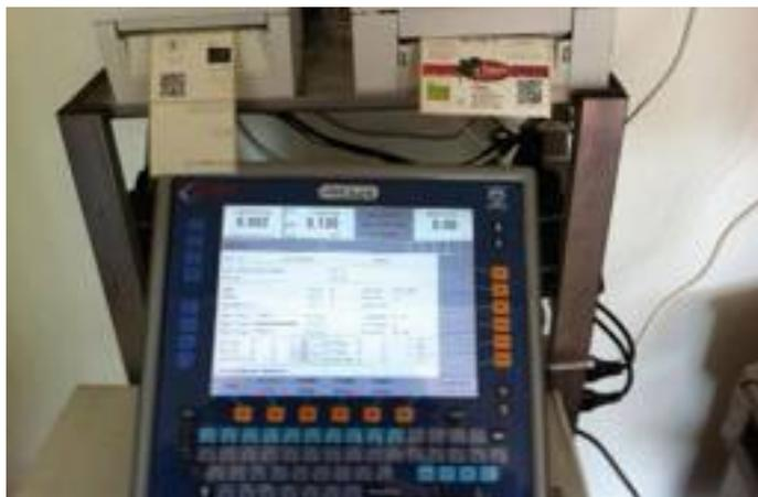
**Nell'azienda Ca' Lumaco, a Montetortore di Zocca (Mo), ogni singolo pezzo di salume e prosciutto prodotto viene pesato e registrato dal computer, poi dotato di etichetta con un codice a barre che riporta tutti i dati della tracciabilità.**
