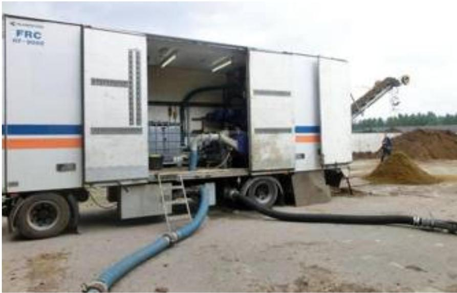
● **Figura 11** – Una attrezzatura mobile di separazione in azione presso un allevamento di bovini da latte in Olanda. Il rimorchio comprende anche un generatore di corrente che rende il suo funzionamento autonomo dall'allevamento ospite.
