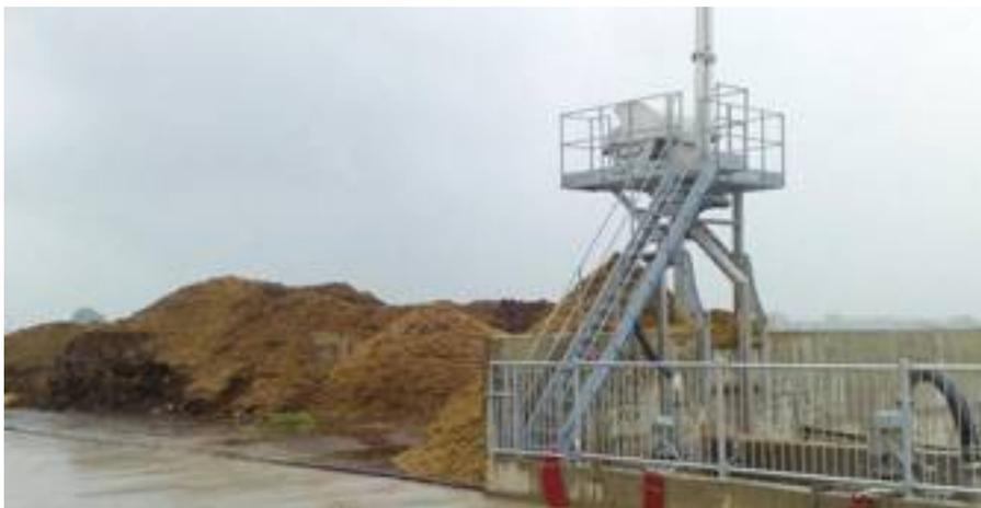
● Figura 8 – Un separatore a rulli prementi con sullo sfondo la concimaia per l'accumulo del letame e della frazione solida separata.
