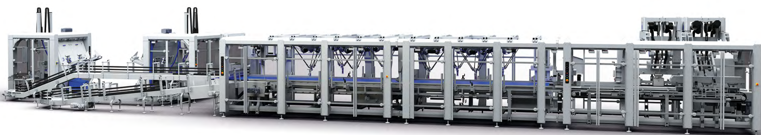
Unità monoblocco per caricamento e chiusura robotizzata (Fonte: Cama Group)
