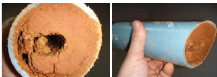
Figura 20 - Il ferro precipita e intasa le ali gocciolanti e i gocciolatori (Fonte: Dr. Ivan Vidal, UdeC).
