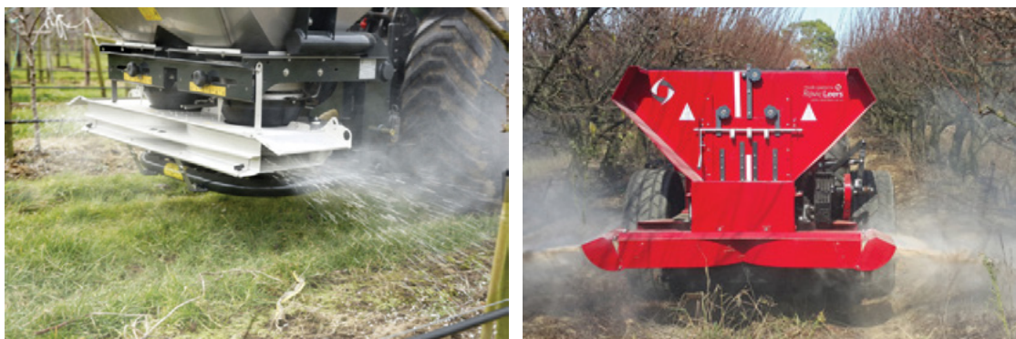
Figura 15 - Esempio di spandiconcime a bande superficiali (Fonte: www.eurospand.com )
