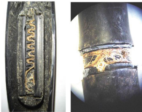
Figura 34 - Percorso all'interno del gocciolatore e orifizio ostruiti dalle radici della pianta.
