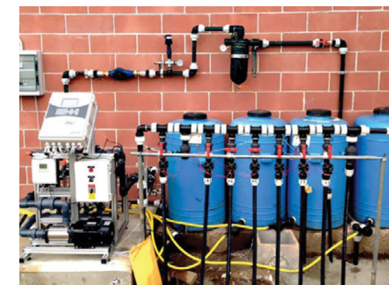
Figura 47. Banco di fertirrigazione altamente automatizzato (da: sito web Agricolplast).
