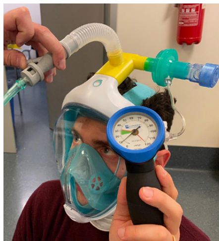
Le Charlotte valve e le valvole Venturi stampate in 3D, così come il kit Easy-Covid19 stampato a iniezione sono stati testati in ospedale su persone sane dimostrando la piena funzionalità
