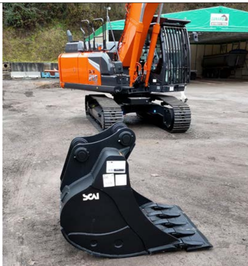
Una delle benne da roccia fornite da Scai con l'escavatore
