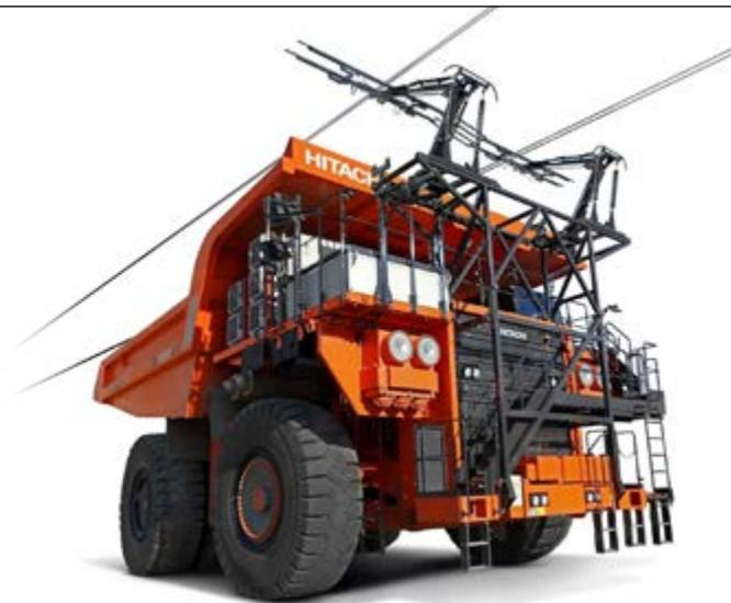
prevede che il veicolo sia in grado di funzionare in modo continuo grazie alla rete esistente di linee di ricarica aeree abinate al sistema di frenata rigenerativa del prototipo.
