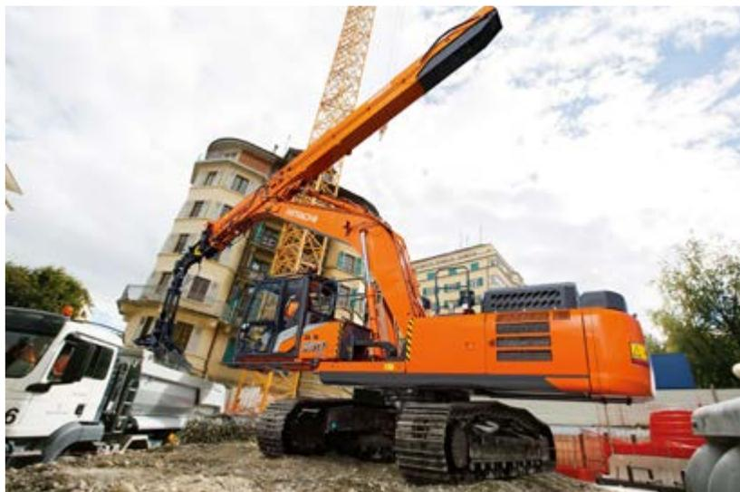
Con lo Zaxis 350 LC di Hitachi la sostituzione attrezzi è veloce grazie al sistema di innesto potenziato
