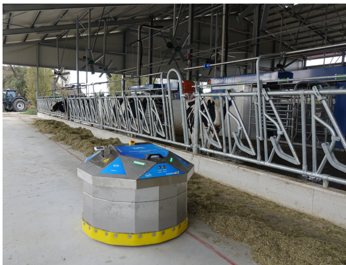
Il robot spingiforaggio Ranger V3, che procede autonomamente
