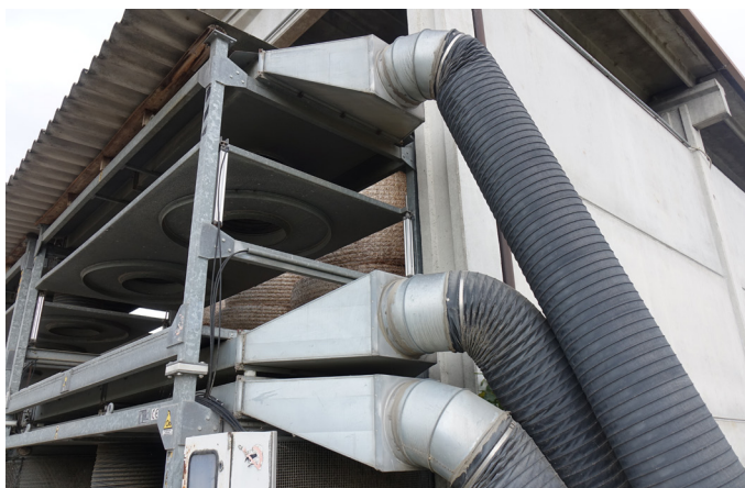
L'impianto di essiccazione per il fieno nel quale le rotoballe vengono posizionate orizzontalmente nei piani; poi, tramite ventole, l'aria calda viene scaricata sia sopra che sotto i balloni, costringendo l'aria a uscire dai lati portando fuori l'umidità
