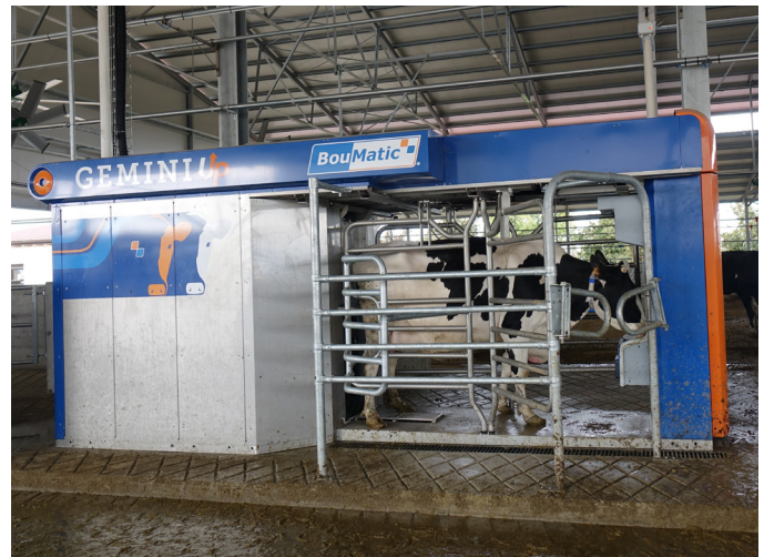
In foto un momento durante la mungitura di una bovina. Uno dei vantaggi principali per cui la Società agricola La Spina ha deciso di acquistare questo robot è la mungitura posteriore
