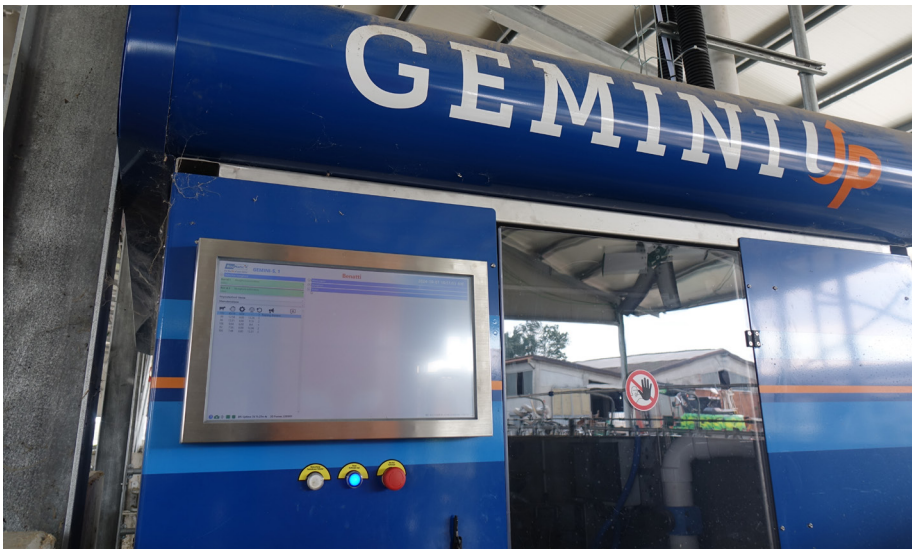
Il monitor del robot fornisce diverse informazioni, come la quantità di latte prodotta da ogni vacca, il flusso del latte e la conducibilità
