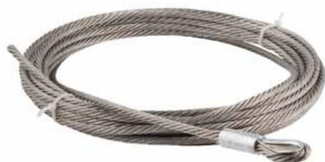
Cavo in acciaio inossidabile AISI 316 con diametro nominale di 8 mm composto da numero 7 trefoli ciascuno dei quali composto da 7 fili. Fornito con una estremità già crimpata, l'altra da redanziare durante la posa in opera tramite terminale di serraggio del cavo.
