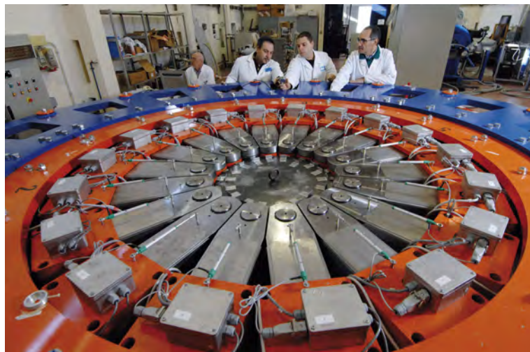
Macchina per il test degli anelli di ITER (In basso) Il Frascati Tokamak Upgrade (FTU)
