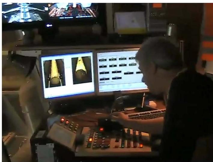
*I tronchi vengono subito scortecciati e smistati sulla linea di trasformazione. Dopo questa operazione un operatore effettua la prima classificazione (essenza, qualità) con un controllo a vista. Tramite una pulsantiera destina i tronchi verso i box di stoccaggio (in cui avverrà anche una selezione in base al diametro automatizzata), per essere accatastati nel piazzale tronchi.*
