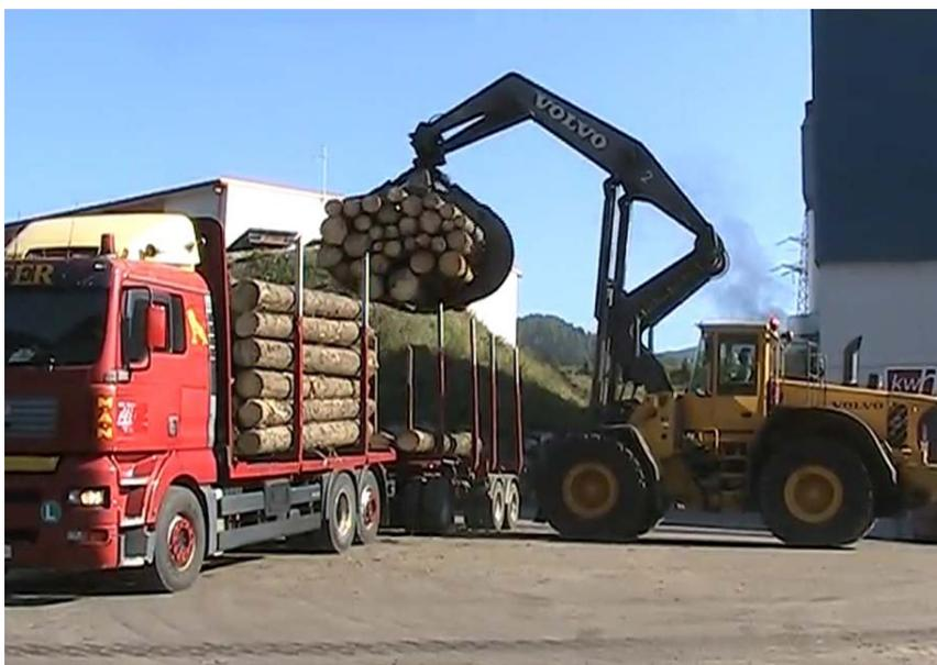
*All'arrivo in segheria i tronchi vengono prelevati "a mazzi" interi per essere immessi nel ciclo di produzione. Il primo passaggio sarà lo scortecciamento del tronco.*
