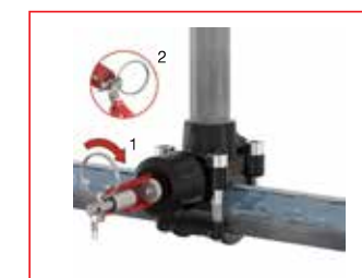
Avvitare il detonatore del T-plus. Posizionare l'anello nella direzione più comoda per essere tirato (1). Tagliare il sigillo (2).
