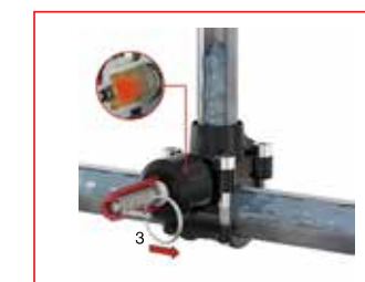
Tirare il perno (3). Viene così praticato un taglio netto nel tubo per realizzare la derivazione. Fatto!
