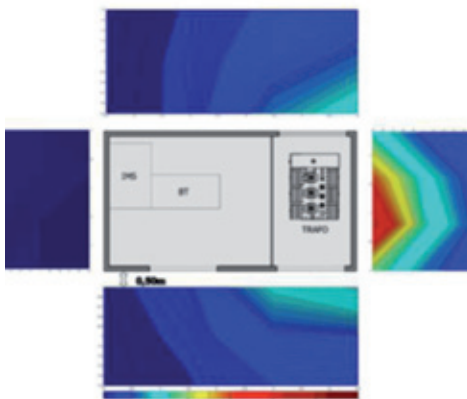
Figura 4.15: Esempio di distribuzione spaziale del vettore induzione magnetica B [ \mu\text{T} ] attorno la cabina
