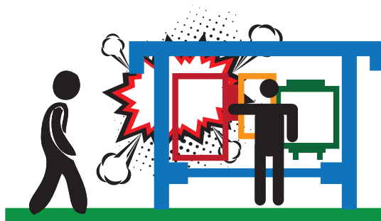
Figura 1.21: Classificazione arco interno IAC-AB
