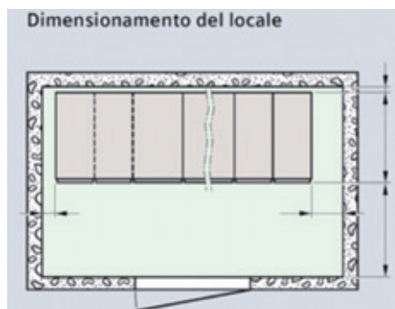
Figura 5.4: Posizionamento del quadro MT nella cabina
