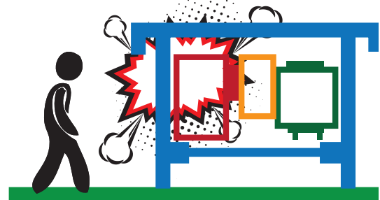
Figura 1.20: Classificazione arco interno IAC-B
