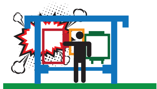
Figura 1.19: Classificazione arco interno IAC-A
