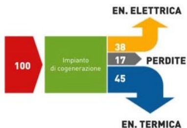
Schema funzionale di un impianto cogenerativo
