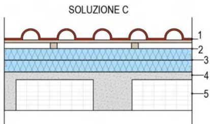
Figura 1 Soluzioni di copertura analizzate, dati termofisici dei materiali componenti le stratigrafie.
