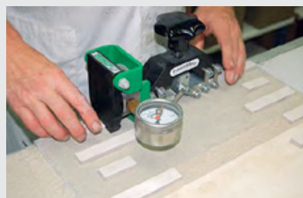
C) Prova di shear mediante apposita strumentazione (Pressometer - misuratore idraulico di forza di taglio)
