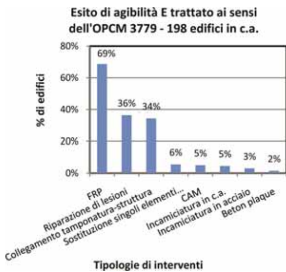
Figura 3.15. Interventi di riparazione e di rafforzamento locale negli edifici in c.a. con esito E trattato ai sensi dell'O.P.C.M. 3779.
