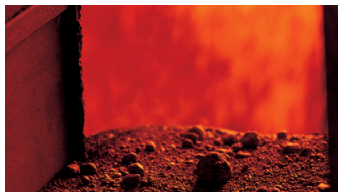
L'espansione e la cottura dell'argilla espansa raggiunge i 1200 °C.
