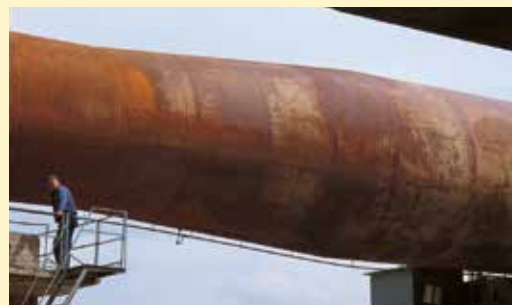
Forno rotante di produzione.
