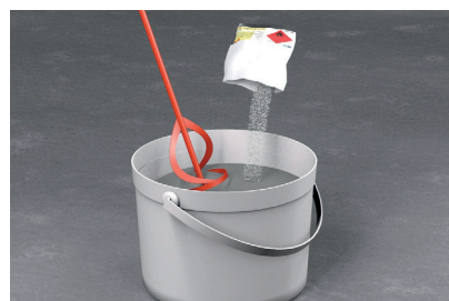
5. Aggiungere il catalizzatore lasciando in funzione l'agitatore a bassa velocità e mescolare per 2 minuti (v. tabella di miscelazione, temperatura e tempo di lavorazione). (Piccole quantità di prodotto possono essere mescolate anche a mano)
