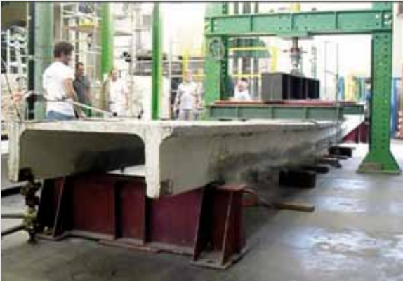
Fig. 4 prova di carico della trave in c.a.p. rinforzata con malta Concrete Rock W e tessuto in acciaio STEEL NET 190.
