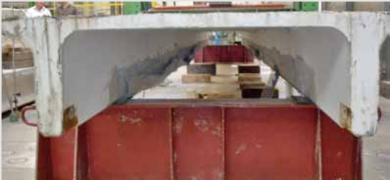
Fig. 6 Test a rottura trave in c.a.p. rinforzata.
