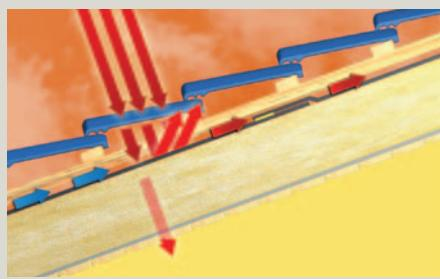
Riflessione del calore grazie alla speciale superficie metallizzata (riflessione del calore per irraggiamento fino al 70%).
