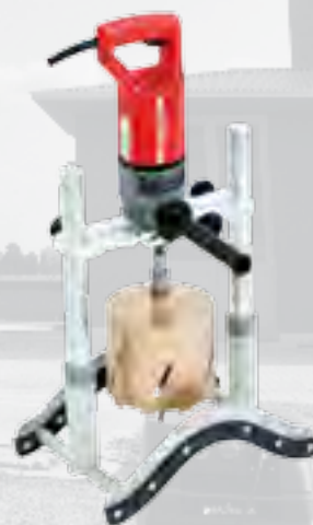
8. COLONNA TUBO semplifica la foratura manuale su superfici ricurve, quali ad esempio tubazioni in cemento di grosso diametro.
