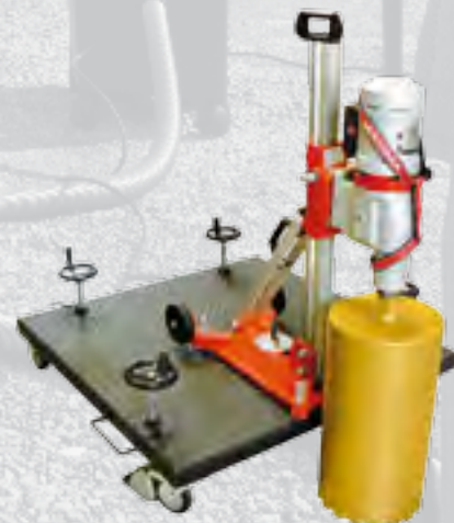
9. CARRELLO BASAMENTO COMPLETO per forature a pavimento con carotatrici su colonna. Evita il tassellaggio a pavimento delle attrezzature e agevola lo spostamento.
