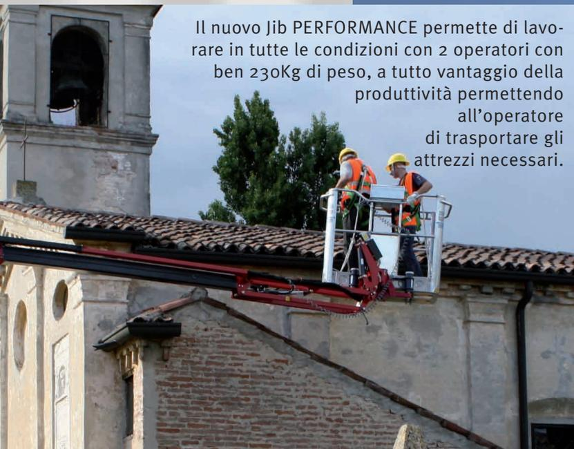
Il nuovo Jib PERFORMANCE permette di lavorare in tutte le condizioni con 2 operatori con ben 230Kg di peso, a tutto vantaggio della produttività permettendo all'operatore di trasportare gli attrezzi necessari.
