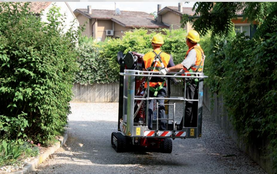
L'innovativo sistema di trazione Auto2Speed permette di raggiungere un'ottima velocità di traslazione: 3,6 km/h per spostarsi velocemente da un luogo all'altro del cantiere. In più grazie al controllo sull'inclinazione la macchina decelera automaticamente in condizioni estreme, a tutto vantaggio della sicurezza per l'operatore.
