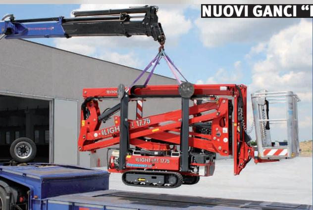
Per movimentazione tramite gru, una volta chiusa la macchina, è possibile movimentarla tramite corde che andranno ad agganciarsi a questi nuovi e pratici ganci per gru alla fine degli stabilizzatori.
