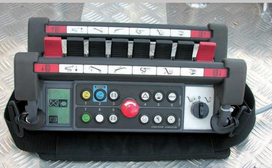
Il telecomando della versione PERFORMANCE III S prevede semplici e comodi comandi quali auto stabilizzazione, movimentazione bracci e traslazione. Un pratico display dona importanti informazioni all'operatore. Il sistema è stato arricchito di nuovi parametri: l'icona service informa l'operatore del momento in cui revisionare la macchina in futuro. L'icona download, permette all'operatore di scaricare sempre l'ultima versione software disponibile per la macchina tramite il modem integrato.
