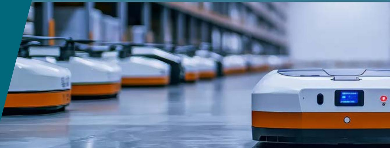
magazzini centrali ai reparti, laboratori e sale operatorie, riducendo, così, il rischio di contaminazione e migliorando la logistica interna. Inoltre, sono in grado di gestire il trasporto di biancheria sporca e rifiuti, aumentando il livello di igiene e sicurezza. Da considerare, però, che l'applicazione in questo settore è ancora preliminare e non ancora altamente diffuso.
