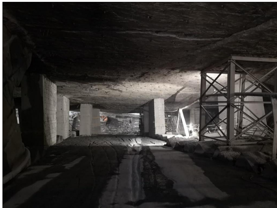
Figure 2. Camere e pilastri di una cava di ardesia
