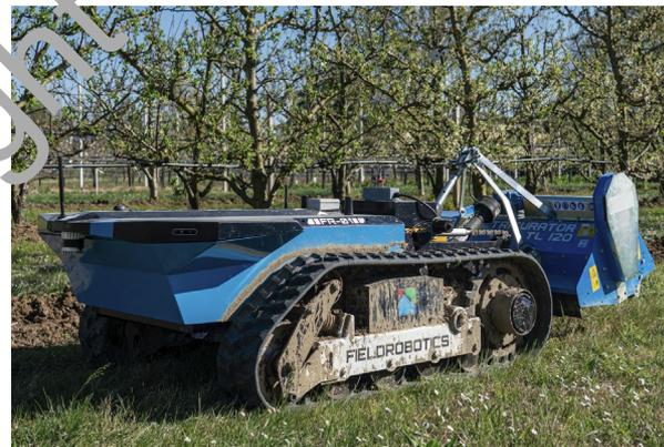
**UNIBO** - Rover autonomo per la coltivazione robotizzata del frutteto che esegue operazioni di gestione e di identificazione/calibrazione dei frutti in movimento.
